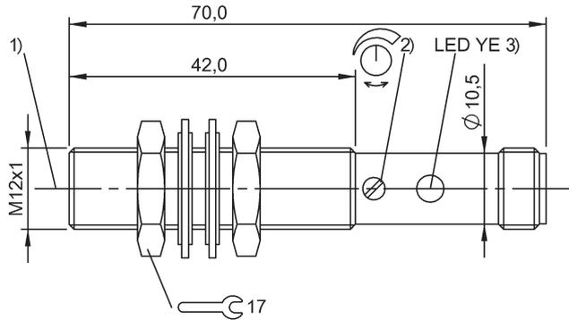
1) Оптическая ось 2) Sn 3) Функция выхода
